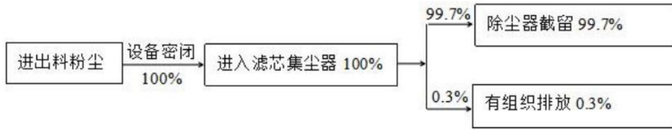
图3-5 舟皿处理粉尘废气处理工艺流程图
