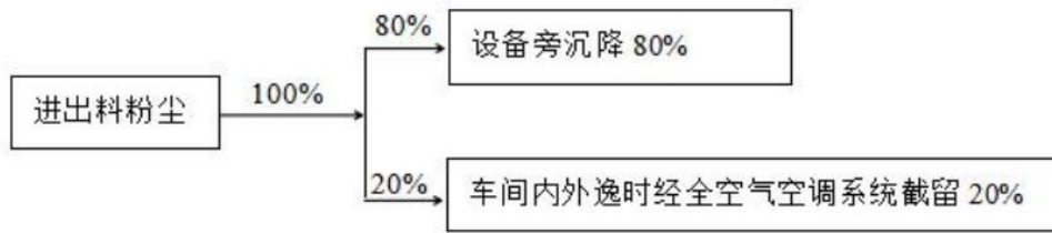
图3-6 项目进出料粉尘处理工艺流程图
